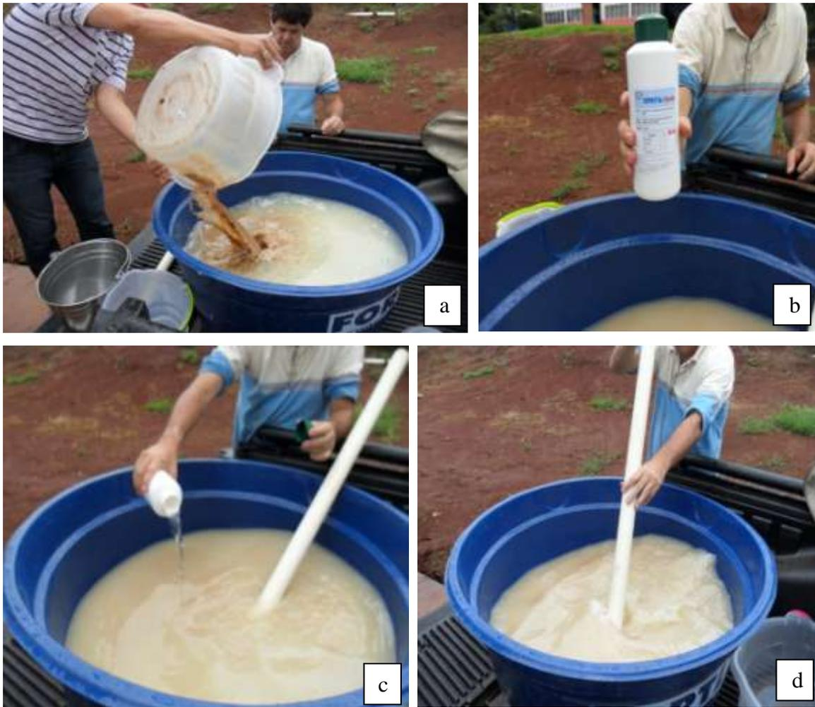
Figura 7 – (a) Disposição do material no tanque de 200 litros; (b) Demonstração do líquido ativador; (c) Adição do líquido ativador; (d) Agitação da amostra (10 minutos)
